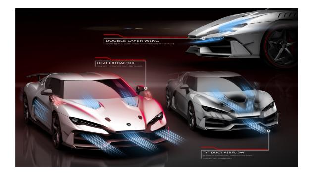
L'air entre donc par la prise d'air centrale, à partir de laquelle il suit un parcours « en Y » précisément, avant de ressortir par les deux ouvertures situées sur la partie supérieure du capot, ce qui crée par conséquent un effet de **déportance**.
