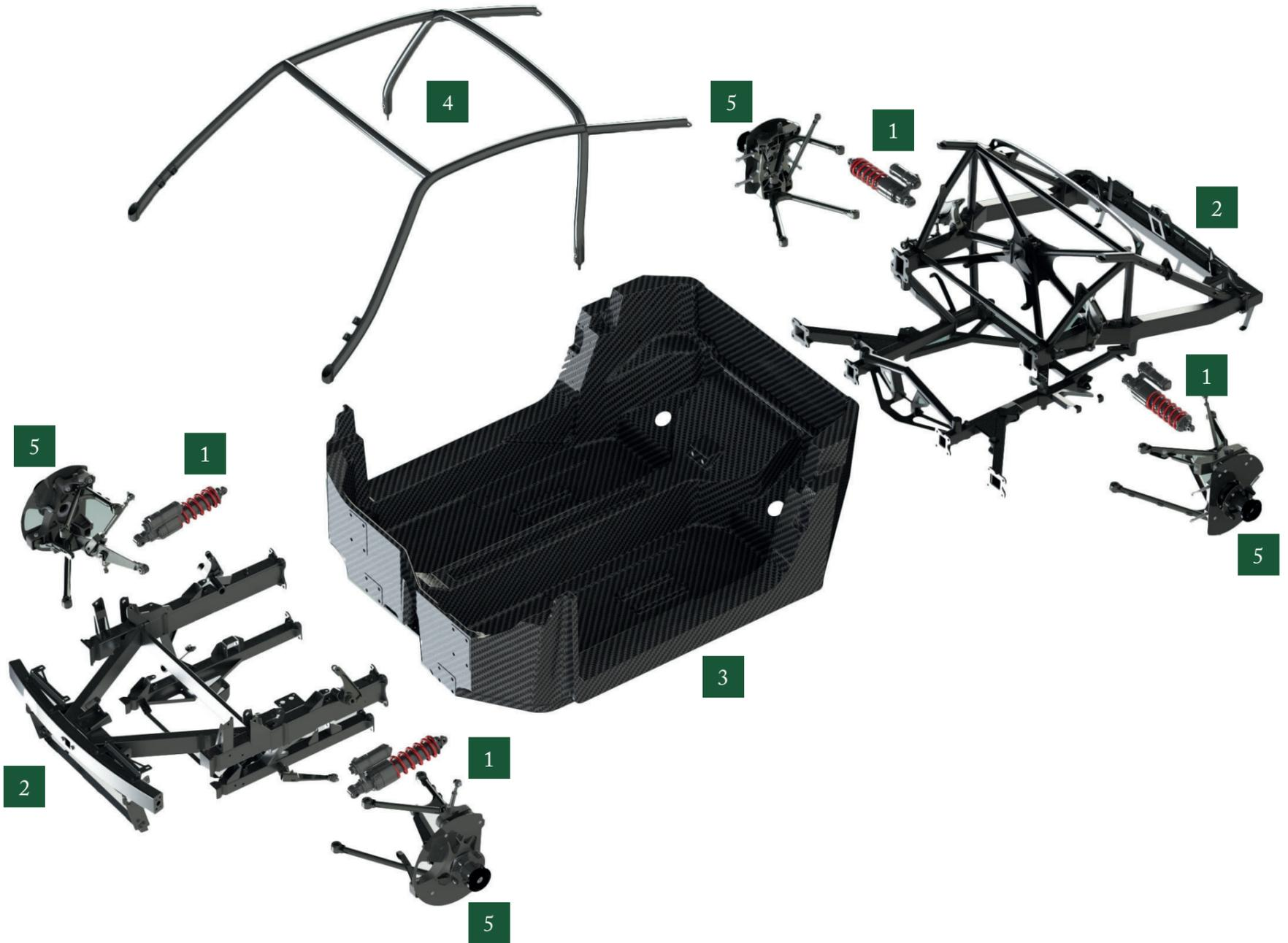
1. Vordere (Längsrichtung) und hintere (Querbauweise) Fahrwerksdämpfer in Pushrod Konfiguration
